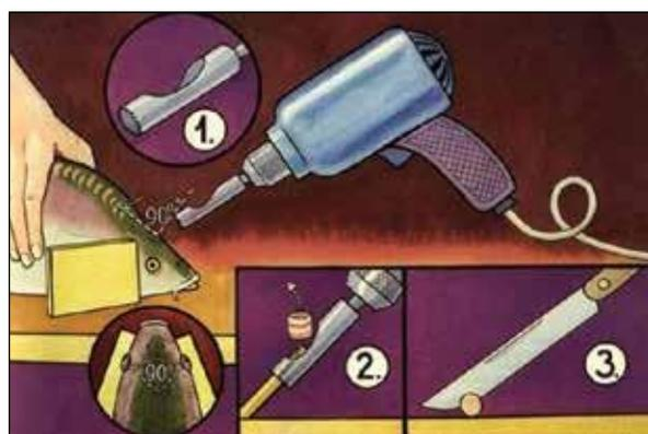
(2) С помощью деревянного пальца, прикрепленного к столу удалите этот цилиндр от головки сверла.
